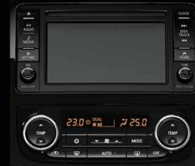
AIRE ACONDICIONADO AUTOMÁTICO CON PURIFICADOR DE AIRE
